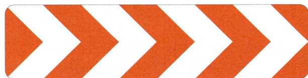
K31.11 Þverslá vegna framkvæmda.
